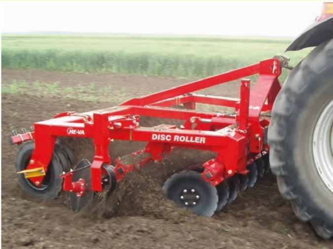
Simple, efficace, une section, porté ou semi-porté, adapté aux tracteurs de 100 C.V. Cela signifie que les exploitations de taille moyenne ont accès à la technologie, au travail rapide et superficiel du Disc-Roller réduisant ainsi leurs coûts.
