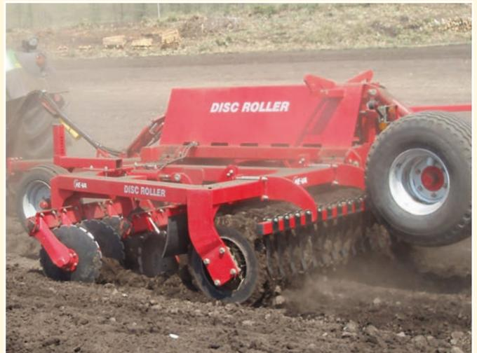
Idéal pour les grandes exploitations, conçu en 2 sections pour tracteurs à partir de 130 C.V., il travaille à grande vitesse pour l'obtention d'un mulch idéal. Ces largeurs portées ou semi-portées correspondent à la puissance moyenne des tracteurs, offrant à l'exploitant la possibilité d'utiliser pleinement les créneaux disponibles de beau temps.
