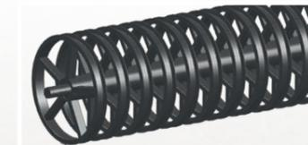
Il rullo con profilo a U è progettato in modo tale che il rullo si riempia di terra durante il funzionamento, questo per ottenere una buona compattazione suolo-suolo e conferire alla superficie del terreno una struttura naturale evitando così una liscivatura.
