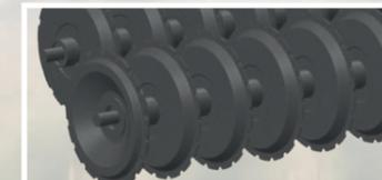
Un rullo doppio è buona soluzione per essere liberi dalla manutenzione, perché i rulli si puliscono a vicenda durante le lavorazioni. Il rullo doppio con profilo a V lascia il suolo ondulato, con un effetto drenante e il risultato è un riscaldamento ed asciugatura più rapida.
