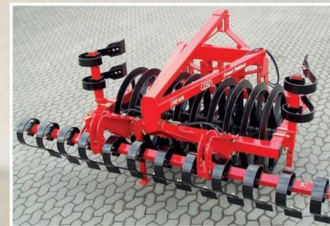
Schleppers, und die Räder/ Zwillingräder des Schleppers sichern eine Rückverfestigung der restlichen Arbeitsbreite. Das 4 m Spring-Board für den 1,65 m Front-Pakker lässt sich mechanische auf eine Transportbreite von 2,85 m umstellen.
