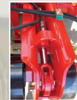
An allen Maschinen mit Spring-Board ist der Arbeitswinkel der Schleppzinken während der Fahrt hydraulisch verstellbar, und die Schleppzinken lassen sich nach Bedarf ganz anheben.
