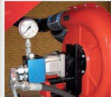
Débit d'huile exigé de 10 à 17 l/min. Une soupape de sécurité protège le moteur hydraulique des surcharges.
