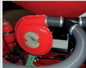
Le manomètre, standard sur la turbine hydraulique, indique la vitesse actuelle de rotation de la turbine. La vitesse de rotation peut être réglée via l'hydraulique du tracteur.
