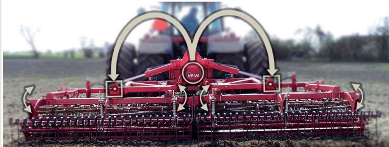
HE-VA Terra-Dan MKII est remarquable par ses deux sections totalement indépendantes et articulées sur un axe central. Ce système assure un suivi parfait du terrain et permet de répartir le poids du châssis, des roues, de la barre d'attelage (O) sur toute la largeur de travail avec un système de report de charge (voir photo).
