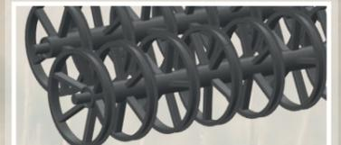
Un rouleau double est une bonne solution sans entretien car les rouleaux se nettoient les uns les autres pendant le fonctionnement. Le rouleau Twin U-profil offre un bon compactage du sol sans lissage.
