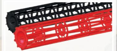
Le rouleau double Ø550/Ø410 mm est constitué d'un rouleau tubes carrés de Ø550 mm et d'un rouleau à barres plates de Ø410 mm. Le rouleau double est recommandé pour affiner et niveler les sols secs, mi-lourds à légers, sans pierres.
