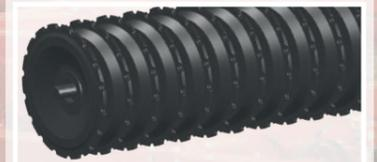
Le rouleau V-profil Ø600 est un bon émietteur qui rappuit en profondeur en laissant un aspect très légèrement billonné ce qui contribue à ce que le sol conserve une bonne capillarité. Les anneaux V-profil sont dentelés, en acier embouti avec un épaulement contrôlant la pénétration. Ces anneaux brisent les mottes résiduelles et retassent les sols lourds, et ils rappuient efficacement sur sols légers. Les décrochtoirs entre les anneaux sont réglables et assurent un excellent décrassage.
