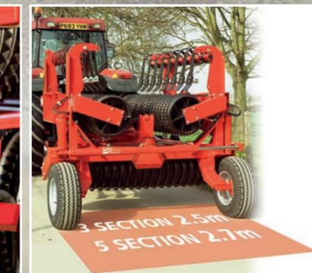
Pour une meilleure stabilité lors du transport, le poids des sections latérales est répartie sur le tracteur est les roues du rouleau.
