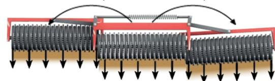
3 Grâce au fait que les trois sections sont pendulaires, le report de charge (le système Actif de Transfert SAT HE-VA) équilibre la pression au sol sur toute la largeur du rouleau.
