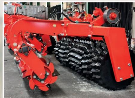
La conception unique présentant une construction à tube fermé empêche le sol et les résidus provenant de la récolte de coller au Top-Cutter et assure un degré d'efficacité continue et élevé. Les six lames à double face assurent un flux de travail régulier et stable.
