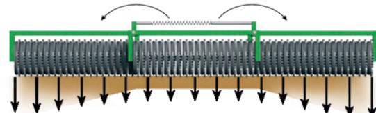
2 De même, avec un système rudimentaire de compensation, sur les rouleaux de base, la pression au sol de l'élément central est inférieure à la pression des sections latérales non pendulaires.
