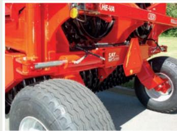
Tous les Tip-Rollers 9,5 m et 10,2 m sont équipés du système SAT avec double ressort qui assure un transfert uniforme sur toute la largeur de travail.
