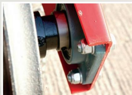
Les anneaux sont montés sur un arbre diamètre 60 mm en acier traité pour une longue durée de vie. Ces arbres sont montés sur des paliers à billes oscillants fixés par 4 boulons et protégés à l'intérieur d'un support en acier profilé en U.
