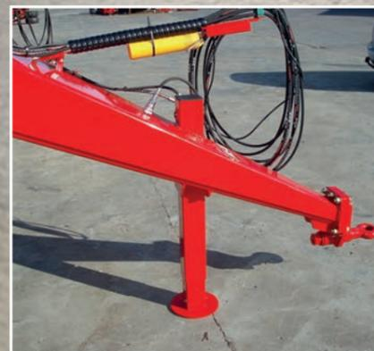
En standard, la béquille est réglable à l'aide de manivelle sur les Tip-Rollers 4,5 m à 8,2 m, et vérin hydraulique sur les 9,5 m et 10,2 m.
