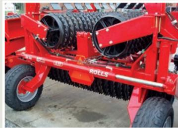
Tous les Tip-Rollers 4,5 - 5,4 m - ainsi que les 6,3 m équipés d'anneaux inférieurs à 600 mm de diamètre sont équipés du système SAT (report de poids) avec un seul vérin de repliage doté d'un ressort compensateur à l'une de ses extrémités.
