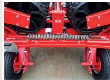
Les Tip-Rollers 6,3 m équipés d'anneaux de Ø 600 / 620 mm, tous les 7,3 m et 8,2 m sont dotés de 2 vérins entre lesquels est disposé le ressort compensateur du système SAT.
