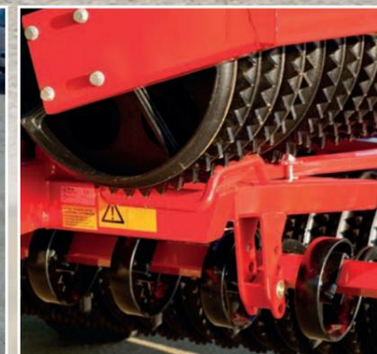
Les berceaux d'appui du Tip-Roller 3 sections, maintiennent fermement en place les sections latérales et le bruit est réduit au transport. Le circuit hydraulique est bloqué.
