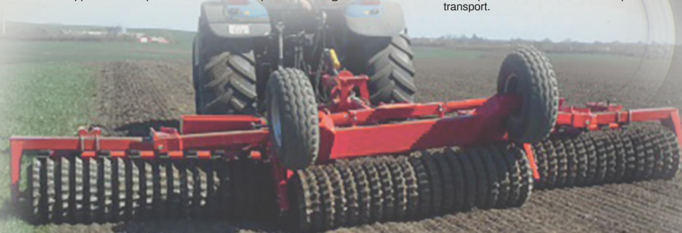
L'efficacité des rouleaux HE-VA en action - niveler, émietter, briser les mottes, retasser et préparer le lit de semences une combinaison d'actions sur une grande largeur de travail.
