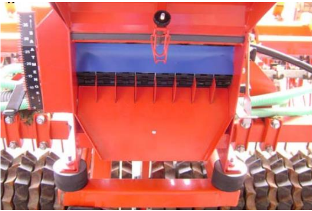
4. Placer l'entonnoir sous le rouleau doseur
