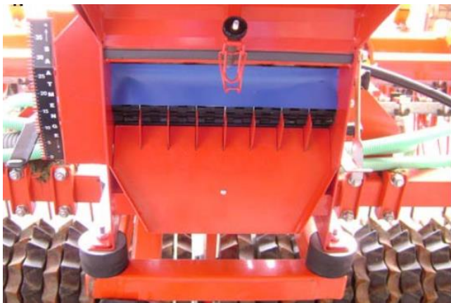
4. Montera vridprovstratten under doseringvalsen
