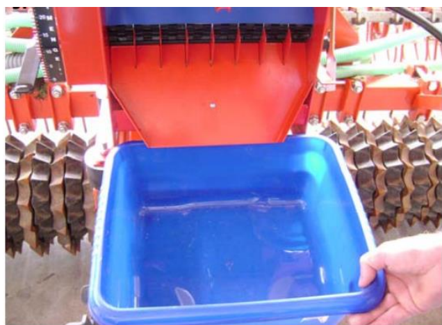
5. Placera behållaren under vridprovstratten
