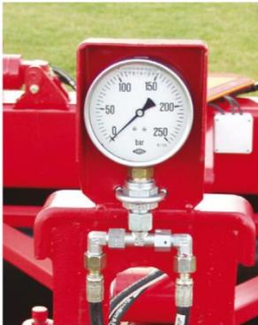
Le report de poids s'effectue sur les deux sections intermédiaires (○) voir photo. Le système S.A.T. permet d'uniformiser la pression au sol aussi bien sur la section centrale que sur les sections intermédiaires et extérieures (□) voir photo.
