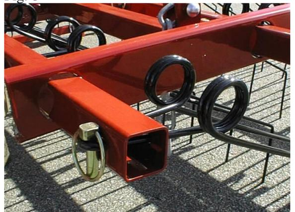
Die Zinken werden schnell durch einen Ringsplint montiert / abmontiert.
