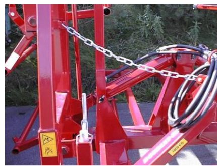
Cadena de seguridad para marcos laterales.
