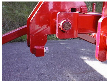
Tope ajustable para los marcos laterales.
