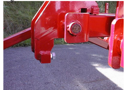
Butée réglable des sections ailes.
