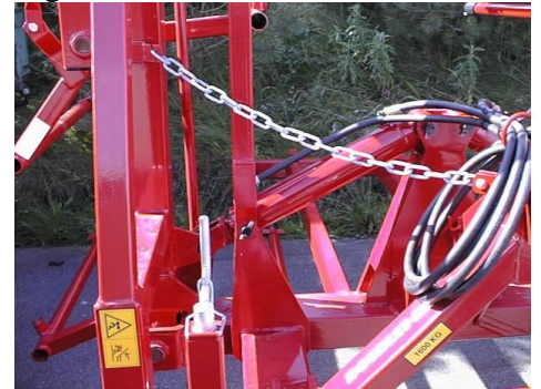
Chaîne de sécurité p/verrouillage des sections ailes au transport
