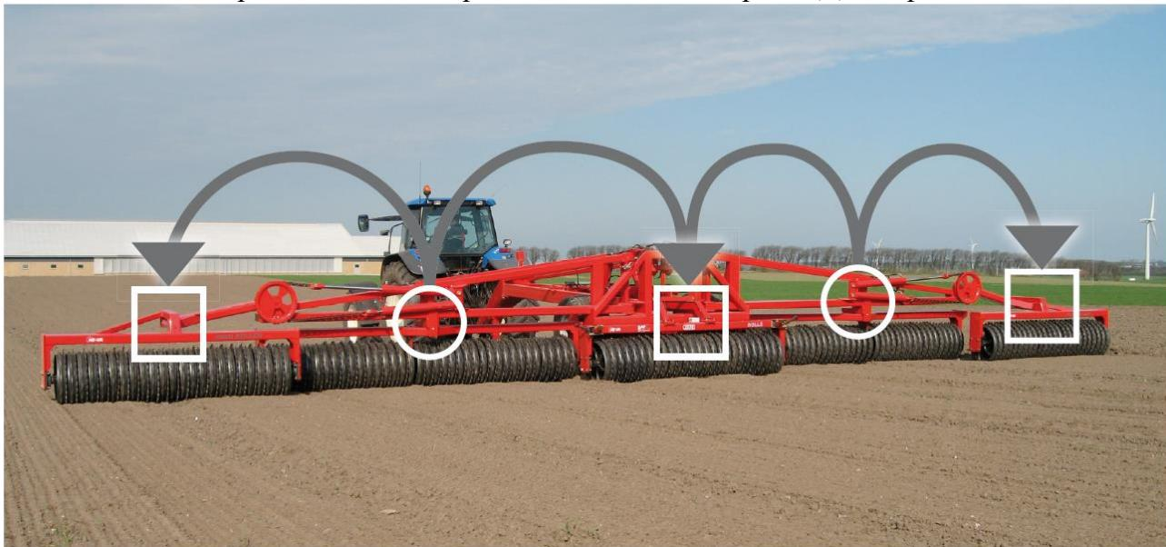
Все пять роликовых секций катка HE-VA King-Roller подвешиваются в центре с независимой проходимостью, что обеспечивает абсолютное прослеживание контуров катка King-Roller
