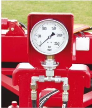
Датчик давления позволяет оператору устанавливать уровень распределения веса, чтобы обеспечить равномерное закрепление почвы по всей ширине. Основная рама катка KingRoller поддерживается двумя секциями крыльев (O) см. фото. С помощью системы SAT необходимая часть веса катка переносится на центр и секции внешнего крыла (□) см. фото.
