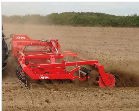
7,50 m lyftburen Terra-Dan MKII med rörvals med fyrkantströr.
