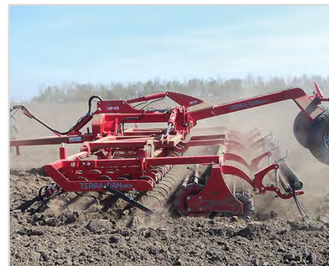
6,00 m bogserad Terra-Dan MKII med dubbelvals och långfingerefterharv.
