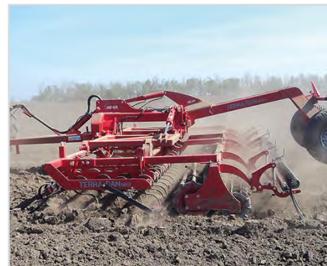
Terra Dan MKII 6,00 m avec rouleau double et herse peigne arrière.
