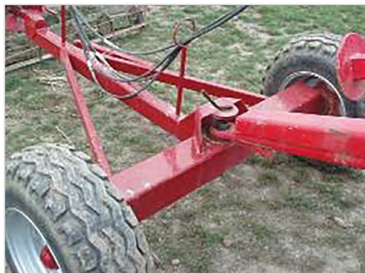
Dolly: Chariot avec roues permettant d'atteler un rouleau derrière le vibroculteur. Roues 11,5/80 x 15,3.
