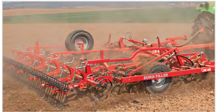
Euro-Tiller 6,00 m avec rangée de dents efface traces, Spring-Board frontale à lames de ressort, Spring-Board arrière, herse peigne arrière et roue de secours.
