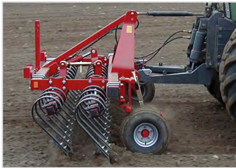
4,00 m Front-Board mit Krustenbrecherscharen.
