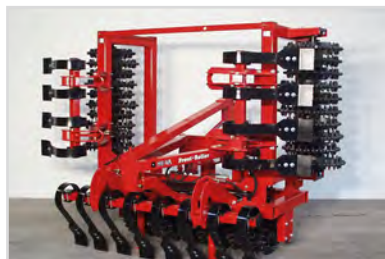
4,00 m Front-Roller m/ Crosskill, hydr. Klappung und Spring-Board.
