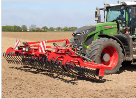
3,00 m Front-Roller Twin mit Ø550/550 mm Sternringen und Spring-Board.
