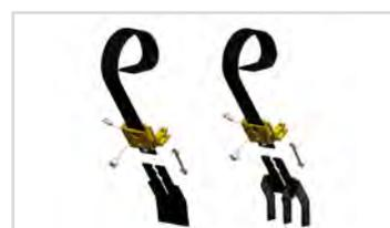
Easy-Change - Schnellwechsel-system der Verschleisschare, einschl. 1 Satz flache Verschleisschare und 1 Satz Krustenbrecherschare mit 3 Zinken.
