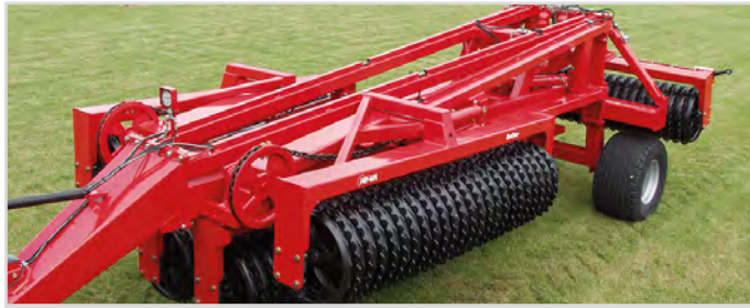
15,30 m King-Roller monterat med 620 mm/24" Cambridgeringe
