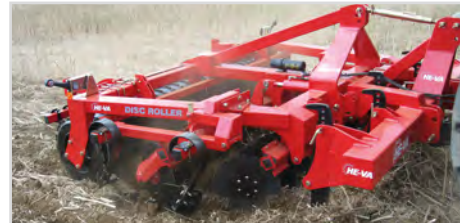
3,00 m liftofhængt Combi-Tiller MKI med 3,00 m liftofhængt Disc-Roller
