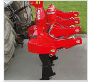
3,00 m Sub-Tiller avec sécurité hydr. automatique et 4 dents
