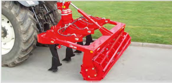
3,00 m Sub-Tiller avec sécurité hydr. automatique, 4 dents, rouleau tubes carrés et réglage hydr. de la profondeur
