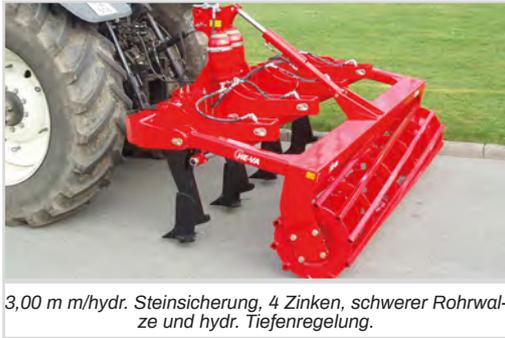
3,00 m m/hydr. Steinsicherung, 4 Zinken, schwerer Rohrwalze und hydr. Tiefenregelung.
