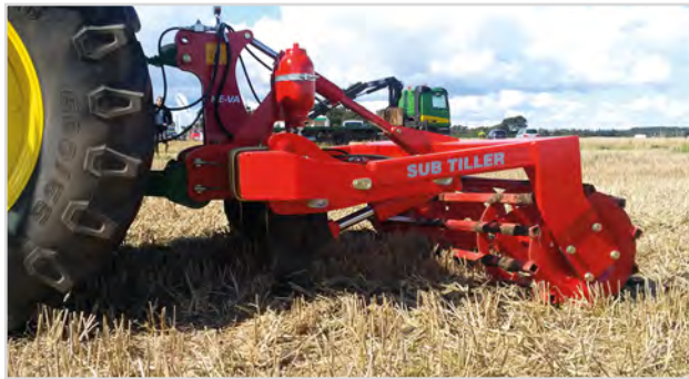
3,00 m med hydr. auto. udløser og 4 tænder
