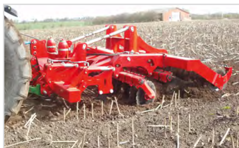
Combi-Disc med alvluckringspinnarna i fullt arbetsdjup. Därmed uppnås alvluckring, kultivering och återpackning.
