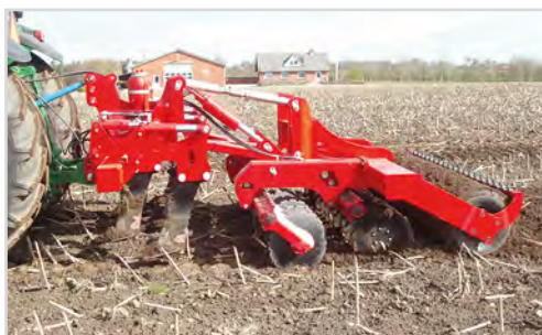
Combi-Disc med alvluckringspinnar lyfta ifrån marken, och därmed är endast Disc-Roller funktionen i arbete.
