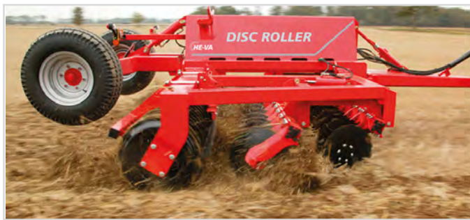
5,00 m avec rouleau V-profil et tablier caoutchouc
