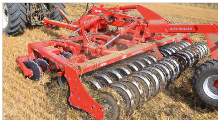
5,50 m Disc-Roller Contour m/Twin V-Profilvals och material-dämpare.
