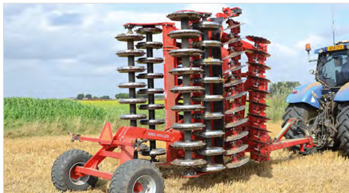
5,50 m Disc-Roller Contour m/Twin V-Profilvals och material-dämpare.
