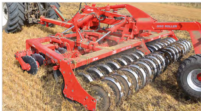
5,50 m Disc-Roller Contour m/Twin V-Profilvalse og materialedæmperskærm.
