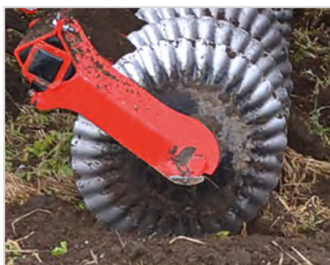
Disque Ø570x5 mm "Sabre-disc" d'incorporation des résidus
