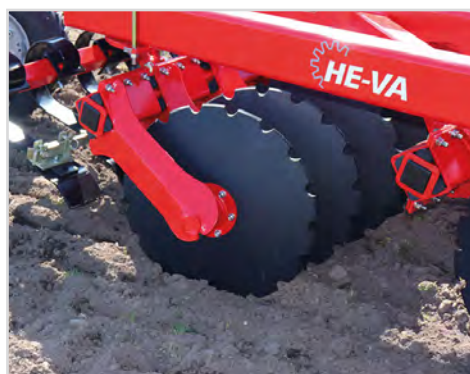
Disque standard Ø610mm – à profil de coupe fine
