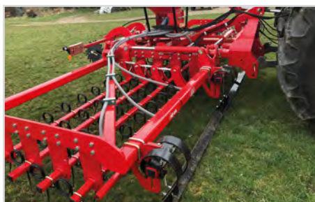
Planierschiene mit mechanischer stufenloser Höhenverstellung
