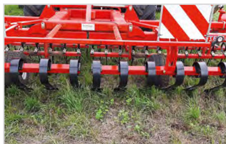
Spring-Board mit mechanischer stufenloser Höhenverstellung
