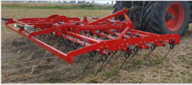
6,00 m Top-Striegel mit 5 Reihen und 16 mm Zinken
