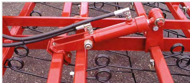
Hydraulisch verstellbarer Zinkendruck
