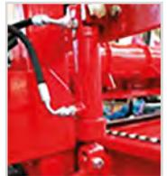
Verrouillage hydraulique du tablier démêleur
