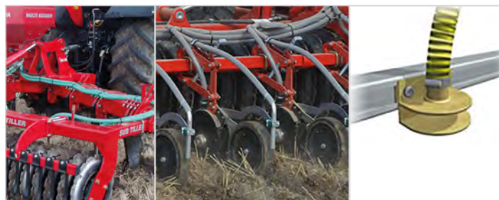
Skivskärssåning med 75 mm breda djuphållningshjul / packhjul. Placerat i 1 rad per pinne efter packvalsen.
