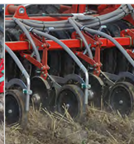
Skiveskærs-såning med 75mm brede dybdehjul / pækkerhjul. Placeret i 1 række pr. tand efter pakkervalse.
