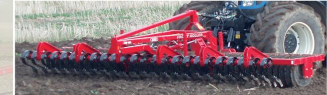
Maschinen mit Spring-Board verfügen über eine hydraulische Einstellung des Bearbeitungsgrades / der Arbeitstiefe, so dass die Aggressivität während der Fahrt angepasst werden kann, oder Spring-Board komplett angehoben werden kann, wenn es die Bedingungen erfordern. Auf der Skala, die vom Fahrersitz aus einsehbar ist, wird der Arbeitswinkel entsprechend der Bodenbeschaffenheit eingestellt.
