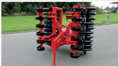
Eine Besonderheit ist der hydr. klappbare Front-Roller 3m. Er zeichnet sich durch eine kompakte Transportbreite aus, welche gerade bei engen Durchfahrten und längeren Straßenfahrten von Nutzen ist.
