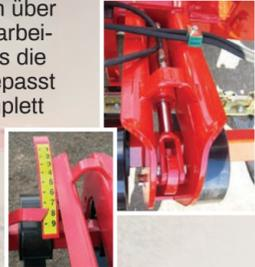
Optional ist auch eine 2- oder 3-reihige Frontegge erhältlich. Sie eignet sich hervorragend zum Aufbrechen und Zerkleinern des Bodens vor der Walze. Die Tiefeneinstellung erfolgt komfortabel über Spindeln.
