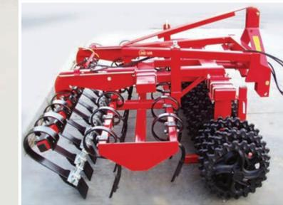
Bei den 1-teiligen Front-Roller-Modellen können auch Frontegge und Spring-Board kombiniert werden (s. Abb.).
