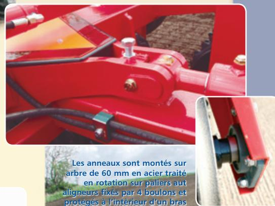
Les anneaux sont montés sur arbre de 60 mm en acier traité en rotation sur paliers aut aligneurs fixés par 4 boulons et protégés à l'intérieur d'un bras profilé en U.
