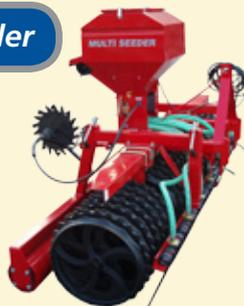
Le kit Grass-Seeder se compose d'une herse étrille avant réglable qui mêle la semence au sol, un rouleau lisse arrière 230mm réglable assurant une parfaite régularité, et les pièces d'adaptation pour semoir Multi-Seeder.
