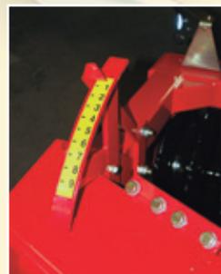
La profondità di lavoro è controllata in modo preciso da un sistema idraulico che regola la posizione del rullo.
