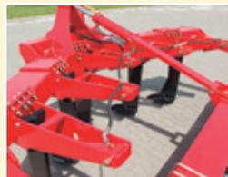
Il sistema protezione pietre Quick-Push consiste in un perno speciale con 6 rotture prestabilite per perno, che si taglieranno quando un dente colpirà una pietra.
