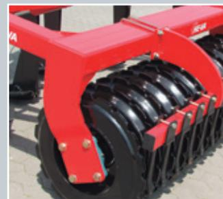
Il rullo da 600 mm con profilo a T chiuso in acciaio pressato con bullone garantisce una rottura delle zolle perfetta. I raschiatori sono posti l'altro e permettono di lavorare in terreni appiccicosi.
