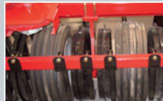
Il rullo Synchronous è un assemblaggio con profilo a "T" Ø 610 mm e ruote 200/60x14.5 poste in corrispondenza del dente/fila di semina. Le ruote di lavoro garantiscono un consolidamento del terreno nel punto dove è stata messa la m...
