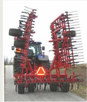
Les axes en retrait autour desquels pivotent les bras de repliage des sections latérales permettent d'obtenir une grande stabilité et une largeur de transport réduite. Un astucieux et robuste système de verrouillage automatique actionné par les vérins hydrauliques rend parfaitement solidaires les sections latérales au bâti central en position route, le déverrouillage s'effectue automatiquement au dépliage.
