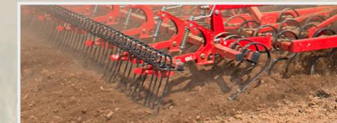
La robuste herse arrière équipée de dents courbes de 12 mm efface et nivelle les sillons laissés par la dernière rangée de dents de vibro, tout en remettant en surface les repousses de mauvaises herbes.
