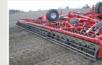
Constitué de barres d'acier plates de 8 x 40 mm travaillant sur la tranche, ce rouleau de 400 mm de diamètre est conseillé sur terres lourdes p/découper et pulvériser les mottes, il structure parfaitement la surface du sol.
