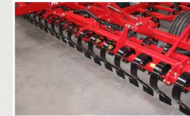
Les lames niveleuses Spring-Board sont un des éléments essentiels de l'Euro-Tiller. Les robustes ressorts à lames 10 x 80 mm, munis de socs palettes 8 x 150 mm, nivellent, écrètent la surface de sol et réduisent par l'effet de percussion la taille des mottes. L'utilisateur peut à l'aide de vérins hydr. doser la pression de ces lames, lors du travail.
