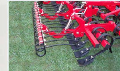
Montées à l'arrière du bâti, ces lames niveleuses assurent la finition du nivellement et contribuent à l'émiettement des mottes restantes, tout en effectuant un travail de rappui. Elles peuvent être combinées avec une herse arrière à dents peignes. La commande hydraulique de ces lames est couplée avec la commande des lames frontales, avec cependant la possibilité de modifier l'appui au sol à l'aide d'une manivelle.
