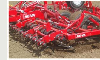
Montée devant les lames Spring-Board, les fonctions de cette première rangée de dents sont les suivants: effacer les traces de roues, briser les mottes, faciliter le travail de nivellement des lames Spring-Board. Avec cette rangée supplémentaire, le vibroculteur aurait 8 rangées de dents, et l'intervalle entre les passages de dents au sol est de 6,4 cm.
