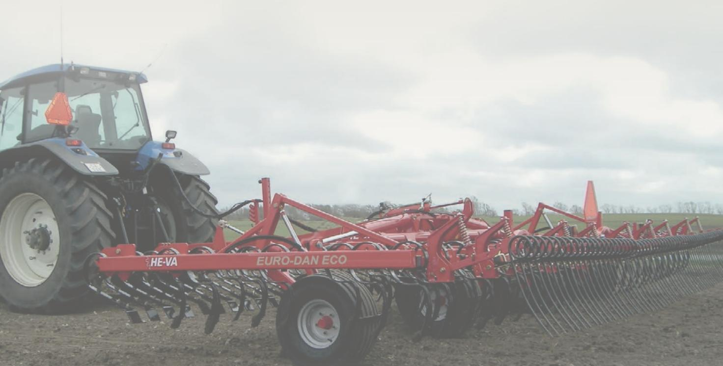
Euro-Dan Eco relevé parallèlement au niveau du sol en appui sur les 4 roues larges de 300 mm. A noter: le dégagement sous les dents est de 40 cm.
