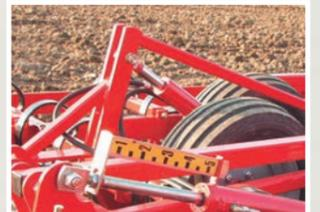
Un indicateur d'angle de travail, disposé sur la section latérale à droite, permet au chauffeur de visualiser facilement la position des lames Spring-Board.
