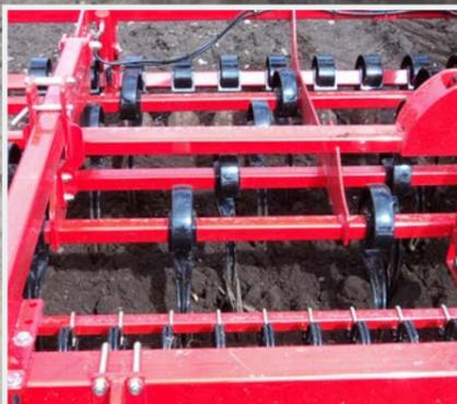
65x12 mm Zinken mit 15 cm Strichabstand für eine leichte Lockerung, um die Struktur der Oberfläche beizubehalten. Erlaubt auch den Einsatz zur leichten Stoppelbearbeitung, ggf. mit 180x6 mm Flügelscharen zur verbesserten Schneidwirkung ausgerüstet.
