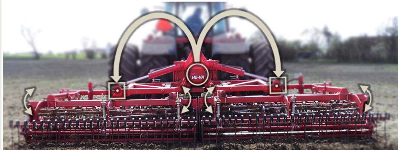
Die Einzigartigkeit am HE-VA Terra-Dan MKII ist, dass er aus einer 2-teiligen, unabhängig voneinander aufgehängten Konstruktion besteht, die der Egge auch in unebenem Gelände eine hohe Flexibilität verschafft und vor allem dazu führt, dass die Oberfläche in auf der gesamten Arbeitsbreite gleichmäßig rückverfestigt wird, da das Gewicht des Fahrwerks und des Rahmens (o) zu gleichen Teilen auf die beiden Eggensektionen übertragen wird (Siehe Foto).
