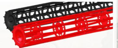
Die Ø550/Ø410-mm-Doppelwalze besteht aus einer schweren Rohrstabwalze mit Ø550 mm gefolgt von einer Flacheisenwalze mit Ø410 mm. Die schwere Rohrstabwalze verfestigt den Boden vor der Flacheisenwalze, die wie ein kräftiger Krümmer funktioniert. Das macht die Doppelwalze ideal für schwerere Böden, da die Oberfläche eine sehr feine Struktur erhält.
