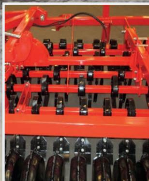
Denti da 45x12 mm con interfila di 8,5 cm per una preparazione del letto di semina fine e uniforme.
