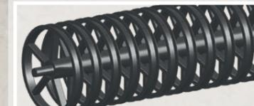
Il rullo con profilo a U è progettato in modo che il rullo si riempia di terra durante il lavoro. Ciò garantisce un buon consolidamento suolo-suolo e conferisce alla superficie del suolo una struttura naturale.
