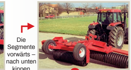
5 Weiter kippen, bis der Zylinder eingezogen ist
