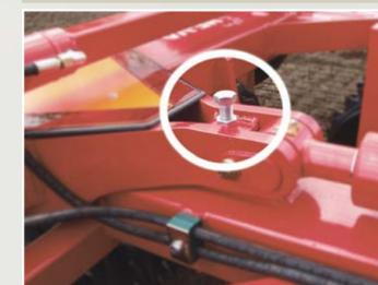
A l'aide d'un simple boulon de réglage, la flèche d'attelage est attelée au tracteur à la hauteur idéal. Les anneaux sont montés sur un arbre de 60 mm en acier traité en rotation sur paliers à triple étanchéité, fixés par 4 boulons et protégés à l'intérieur d'un bras profilé en U.
