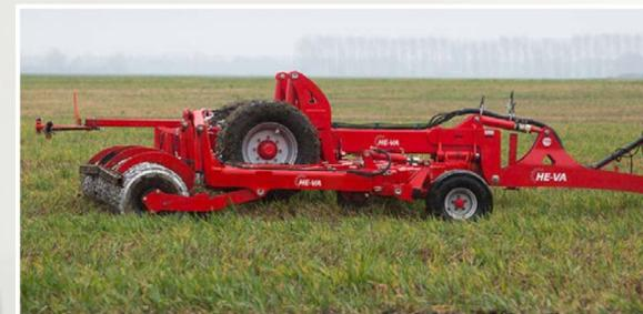
Sub-Tiller semi-portés sont conçus pour fonctionner avec des tracteurs d'une puissance allant jusqu'à 600 cv.
