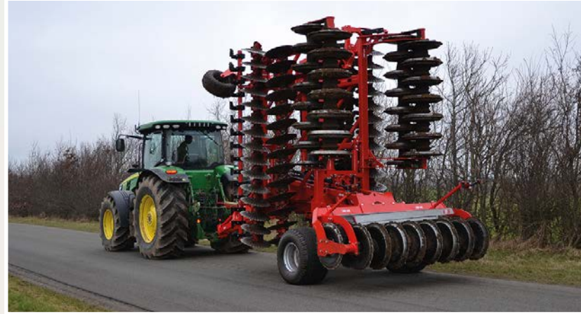
Disc-Roller XL Contour mit 2-teiligen Scheibenteil und 3-teiligen Walzenteil in Transportstellung (6,50 + 7,50 m)
