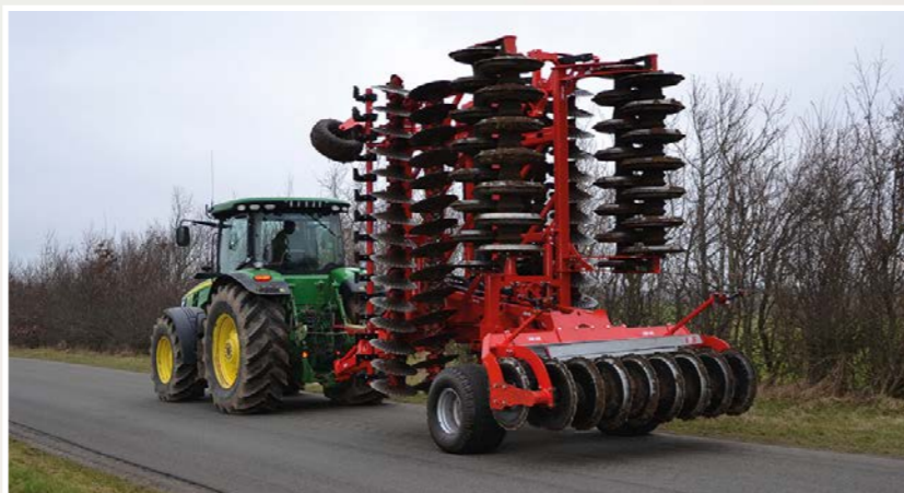
Disc-Roller XL Contour z 2-rzędami talerzy i 3-sekcyjnym wałem w poz. transportowej (6,50 + 7,50 m)
