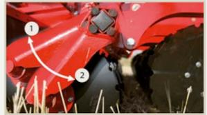
1 Wenn die Maschine für die flache Bodenbearbeitung verwendet wird, steht die Scheibe praktisch senkrecht zum Boden und drückt die Erde seitlich weg, sodass die gesamte Bodenoberfläche entfernt wird. Durch das Losbrechen der Erde anstatt einem „Schaufeln“ kommt es nicht zu einem Verwischen, was zu einem Festfahren der Scheibe führen würde.
