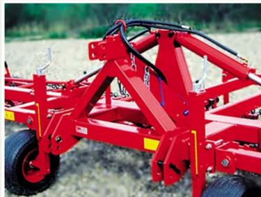
Attelage sur 12,00 et 15,00 m. Châssis fixe renforcé.
