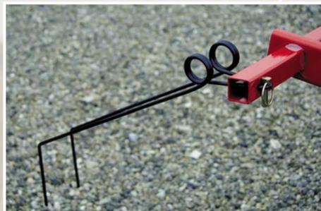
Les sections pendulaires de 1,50 m des herse étrilles Weeders s'adaptent parfaitement aux contours des sols.
