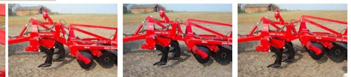
Lorsqu'il est associé à un Disc-Roller, la profondeur de travail des dents peut être réglée de 50 mm au-dessus du sol jusqu'à une profondeur de travail maximale de 400 mm.
