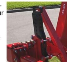
Combi-Tiller MKII avec HE-VA Disc-Roller. Les roues de profondeur stabilisent le coin avant de la machine (en option sur les modèles fixes).
