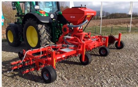
Den standard monterede bagerste snapkobling giver også mulighed for at bruge Grass-Combi i kombination med en bugseret tromle. Her er HE-VA Tip-Roller den idéelle løsning.
